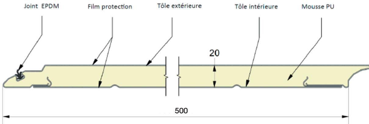
**Solidité** : Le système monocoque induit une liaison entre l'intérieur et l'extérieur du panneau, ce qui accroît sa rigidité.
